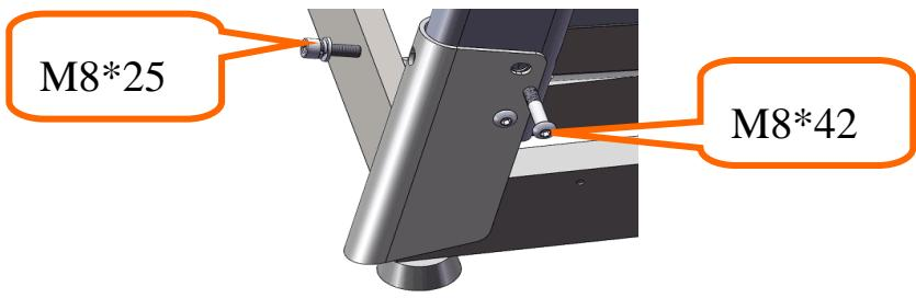
Шаг 3. Держите левые и правые колонны, с помощью шестигранного ключа с внутренним шестигранником 6# зафиксируйте консольную раму на колоннах с помощью винта M8\*25.
