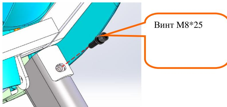
Шаг 4. Достаньте дисплей и с помощью комбинированного ключа открутите винты на задней крышке. Оставьте винты в стороне, чтобы использовать их позже.
