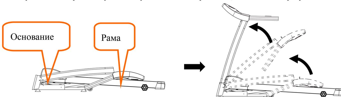
Шаг 2. Используйте шестигранный ключ с внутренним шестигранником 5# и винт M8\*42 для фиксации основания, а затем шестигранный ключ с внутренним шестигранником 6# для крепления вертикальной колонны к основанию с помощью винта M8\*25..
