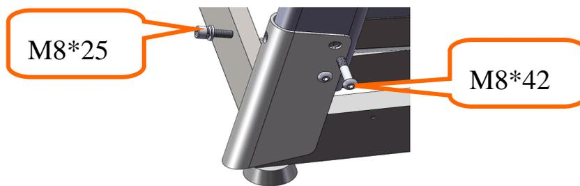
Шаг 3. Держите левые и правые колонны, с помощью шестигранного ключа с внутренним шестигранником 6# зафиксируйте консольную раму на колоннах с помощью винта M8\*25.
