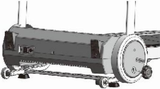
A 3D rendering of the treadmill deck with the two vertical support legs raised and locked into their upright positions.                | <p><b>Шаг 2</b><br/>Ослабьте и вытяните фиксатор с левой стороны, поднимите левую и правую стойки вертикально. Затем закрепите их в таком положении при помощи фиксатора.</p> |
