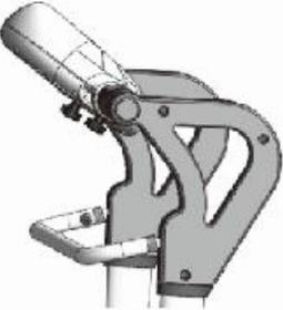
A close-up 3D rendering of the treadmill's console, showing the adjustment mechanism for the display screen.                          | <p><b>Шаг 3</b><br/>Ослабьте треугольные винты с задней части консоли для выбора подходящего для вас, затем затяните винты.</p>                                               |
